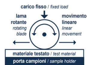
Dal 2003, la resistenza al taglio di un campione preso dal guanto veniva misurata tramite una lama circolare rotante, che vi si muoveva sopra in direzioni alternate e con forza costante, fino a tagliare completamente il materiale. Dal 2016, con l'introduzione del l'ISO Cut Test, si usa una lama piatta, che si muove ad una distanza prefissata, soggetta a forza variabile. Esso è stato concepito per simulare meglio un taglio accidentale o una squarciatura causata da un oggetto acuminateo.
